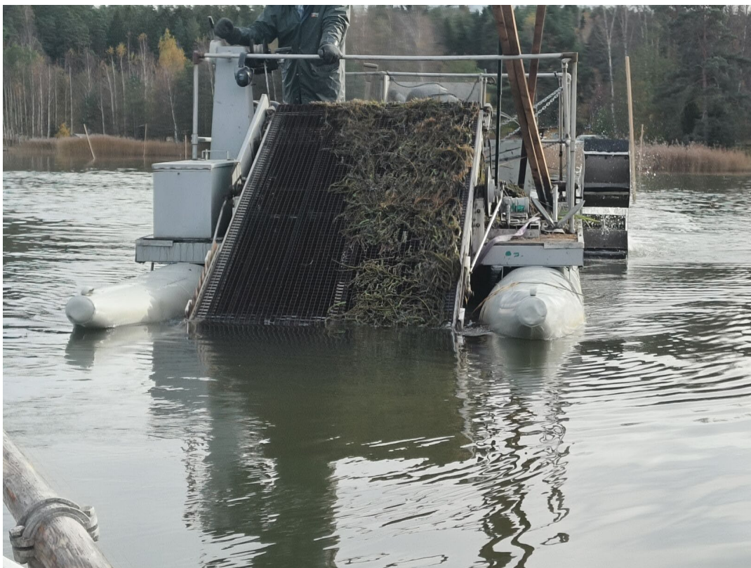
Kuva 8. Niitettyä kasvustoa nousemassa alukselle (Kuva: Sade Palviainen)
